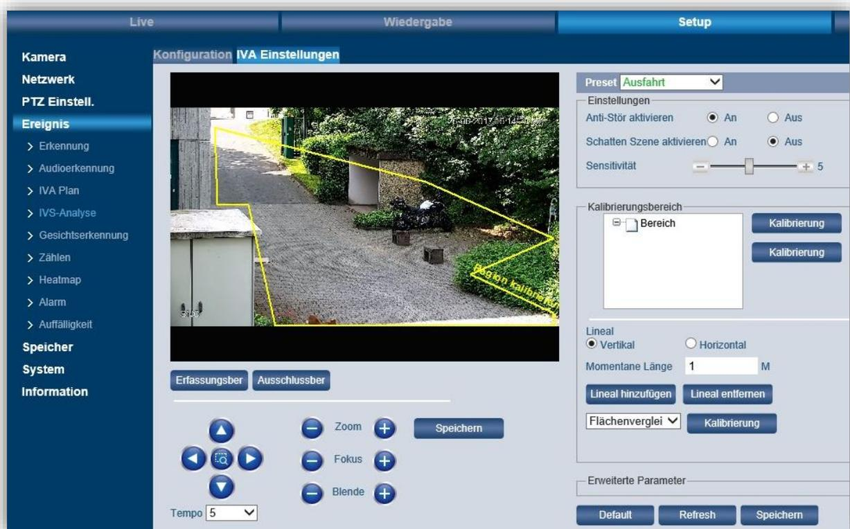
**Hinweis:** Wird kein Erfassungsbereich eingezeichnet, so wird angenommen, dass das gesamte Bild ausgewertet werden soll.
