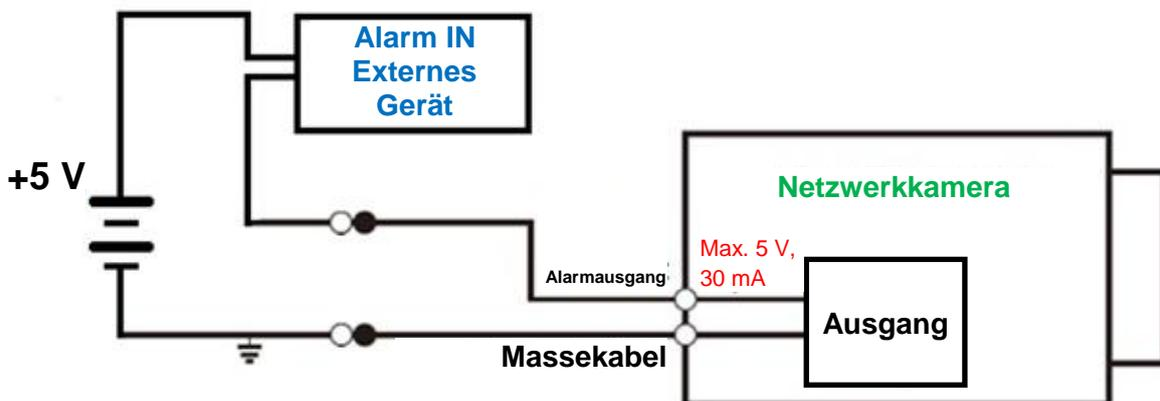
Der Alarmausgang dient der Versorgung des externen Schaltkreises.
