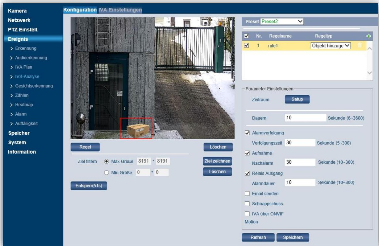
Bei „Hinzugefügtes Objekt“ zeichnen Sie einen Bereich ins Videobild ein. Ein Alarm wird ausgelöst, wenn jemand/etwas in den eingezeichneten Bereich eindringt/zurücklässt oder sich länger als erlaubt (Dauer) dort aufhält.
