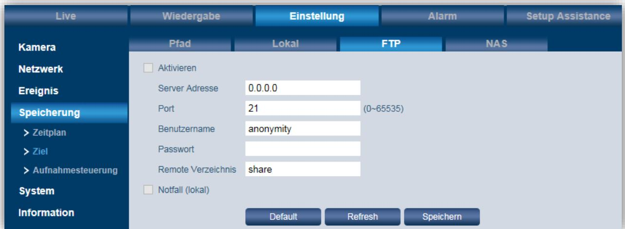
Um Dateien auf dem FTP-Server zu speichern, setzen Sie bitte ein Häkchen bei „Aktivieren“. Geben Sie die Parameter des FTP Servers ein. Stellen Sie sicher, dass sich der FTP-Server und das Gerät im gleichen Netzwerk befinden.
