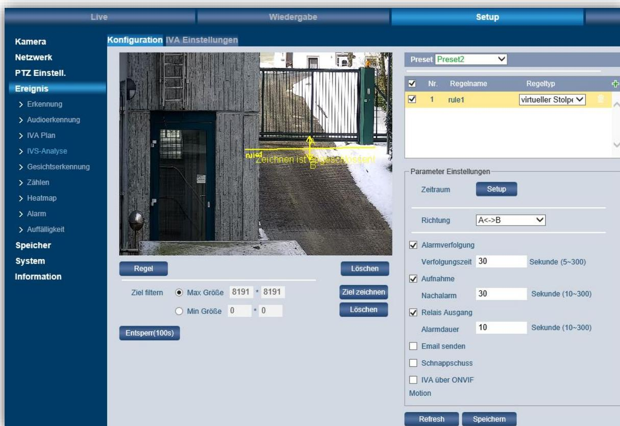
Beim „Stolperdraht“ zeichnen Sie eine Linie (= virtuellen Stolperdraht) an die Stelle ins Videobild ein, bei deren Überschreitung ein Alarm ausgelöst werden soll.
