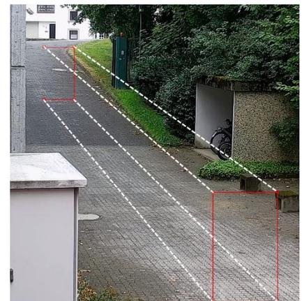
Objekte kleiner (größer) als der Min. (Max.) Rahmen werden dann von der Analyse ausgeschlossen.
