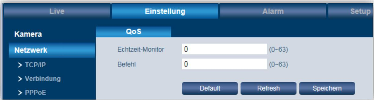
Durch QoS (Quality of Service) werden Datenpakete im Netzwerk-Traffic nach Dringlichkeit (Übertragungspriorität) übertragen, was besonders bei einer starken Auslastung oder gar Überlastung des Netzwerks von Wichtigkeit ist. Nach dem DSCP (Differentiated Services Code Point) Ansatz werden Datenströme anhand bestimmter Merkmale eingeteilt und mit DSCP gekennzeichnet. Diese erhalten dann eine bevorzugte Behandlung seitens des Routers.
